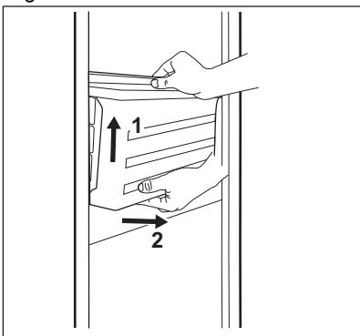
4. Potisnite vodila v napravo, da preprečite poškodbe pri zapiranju vrat.
