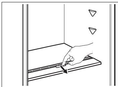
Če želite odstraniti napravo za nadzor vlage, odprite predal pod stekleno polico in izvlecite pokrov.
