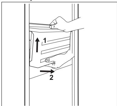
4. Гурните шине у кућиште да бисте спречили оштећивање уређаја при затварању врата.
